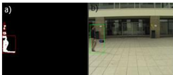
Fig. 8. a) Objetos encontrados para el análisis de las ROI. b) Peatón detectado con los descriptores HOG y LBP.
