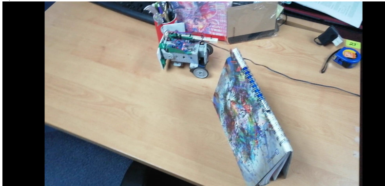
b) El Robot móvil tiene problemas con obstáculos muy pegados a sus costados.
