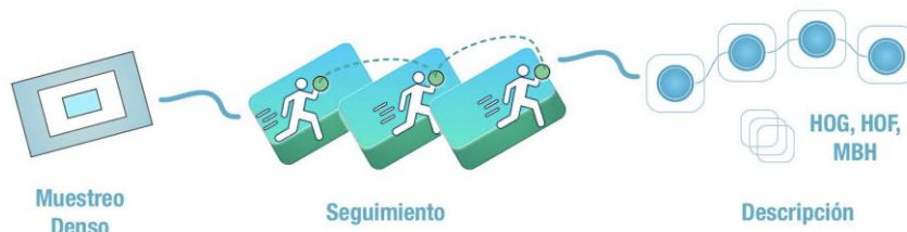
Fig. 1. Proceso de extracción de trayectorias. El proceso de extracción de trayectorias está dividido en tres fases: Muestreo, seguimiento y descripción. En la fase de muestreo se generan una serie de puntos de interés en diferentes escalas de la imagen. La segunda fase tomará cada escala de manera independiente y realizará un seguimiento de los puntos de interés a lo largo de L cantidad de cuadros. Por último, la trayectoria formada por el seguimiento de los puntos debe de ser descrita tanto en su forma, movimiento y apariencia local por medio de los descriptores HOG, HOF y MBH.
