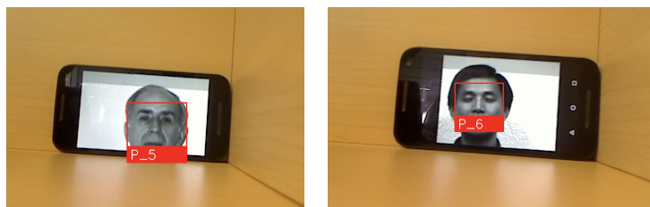
Fig. 13. Pantallas de ejemplos del sistema de reconocimiento de rostros portado, usando la pantalla de visualización de un dispositivo móvil.
