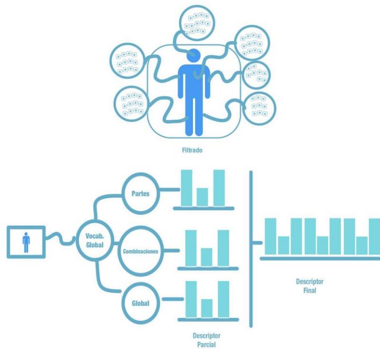
Fig. 4. Nuestra propuesta para mejorar el proceso de reconocimiento de acciones mediante el uso de trayectorias densas. Se añadió un nuevo módulo encargado de asociar las trayectorias con alguna parte del cuerpo. Posteriormente, cada una de las partes y combinaciones entre ellas serán utilizadas para obtener descriptores parciales, que darán vida a un único descriptor mediante su concatenación. Para acelerar el proceso y mejorar la exactitud proponemos utilizar (DISOF) como elemento de flujo óptico en la extracción de trayectorias.
